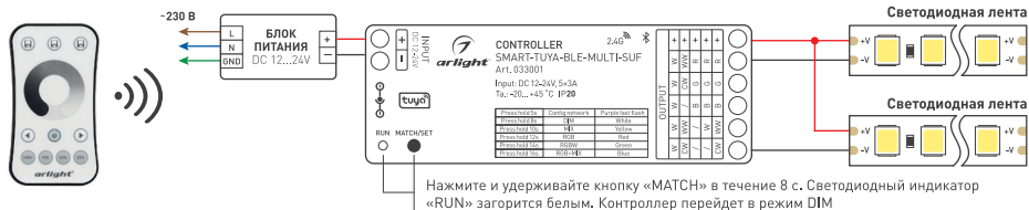
Рисунок 1. Схема подключения контроллера SMART-TUYA-BLE-MULTI-SUF
